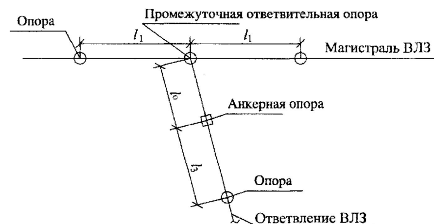
Схема отведения от ВЛ на промежуточной опоре П20-3Н
