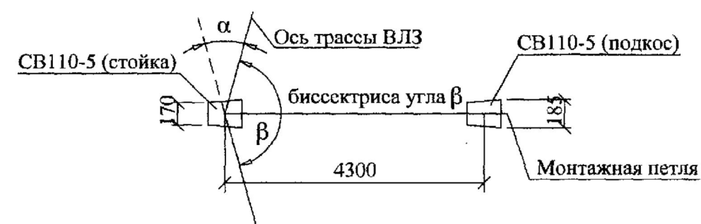
Схема установки стойки и подкоса
